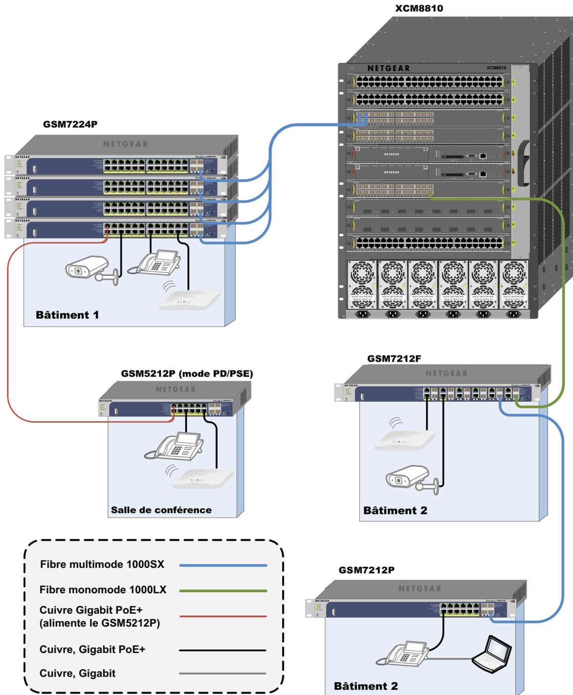
Ces switches manageables de niveau 3 PoE+ sont complémentaires des switches GSM7224 / GSM7248 avec ses 64 interfaces IP pour un routage VLAN :
